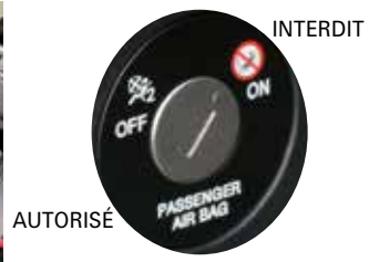
▲ Introduisez la clé de contact dans la commande située près de la portière passager avant et tournez-la en position OFF pour désactiver l'airbag.
